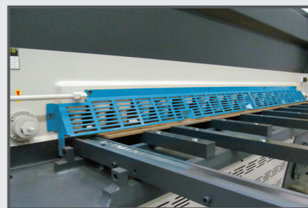
Butée d'équerrage et support avec ou sans réglage encastré, rainure et T cliquet escamotable. Butées d'équerrage de 1000 à 6000mm. Supports avant de 500 mm à 3000 mm.
