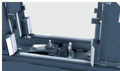
Unité de marquage - fraiseuse 4 ème axe Milling and marking unit on 4th-face 4-seitiges Fräsen und Markierenheit
